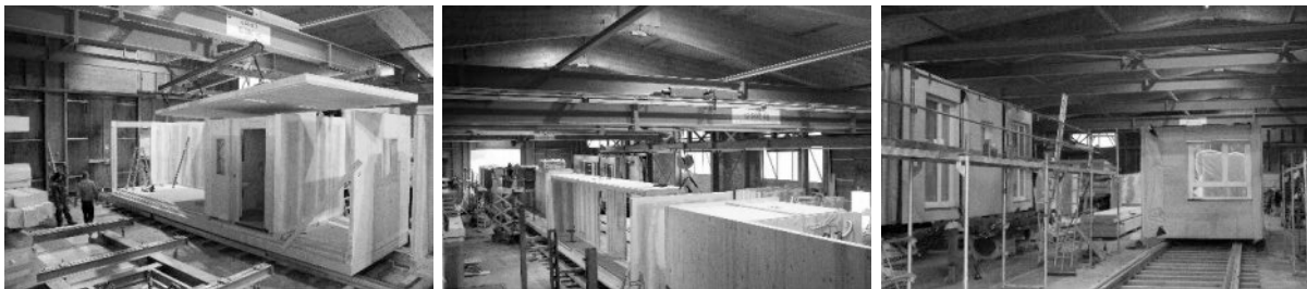
Abbildung 4: Modulmontage in der Feldfabrik
