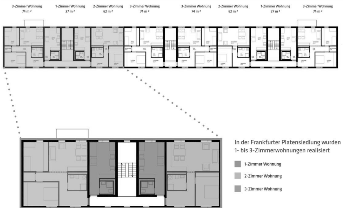
Abbildung 3: Grundriss eines Riegelbaus
