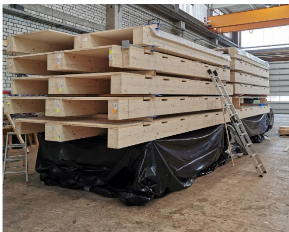
Abbildung 7: Die vorgefertigten Deckenelemente im Werk mit den Kerven für den Verbund
