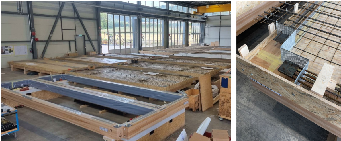
Abbildung 11: Produktion der Holz-Beton-Verbunddecken im Werk der ERNE Holzbau AG
