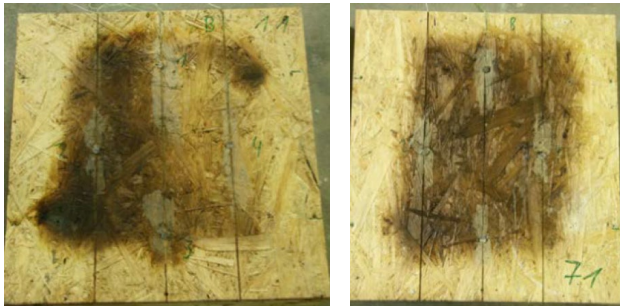
Abbildung 3: Verkohlungserscheinungen hinter 2 x 18 mm dicken Brandschutzbekleidungen, nach 90-minütiger ETK-Beflammung (links) und nach 90-minütiger Naturbrandbeanspruchung «TIMpuls_NB1» (rechts) [2]
