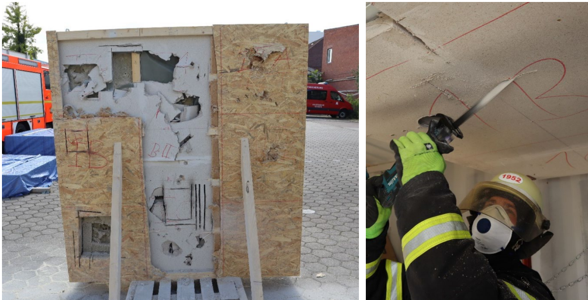
Abbildung 4: Öffnungsversuche an Wand- Deckenprobekörpern
