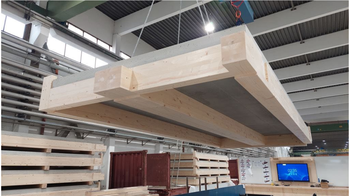
Abbildung 6: vorgefertigte Deckenelemente werden auf Güterwagons verladen (Oberndorfer)
