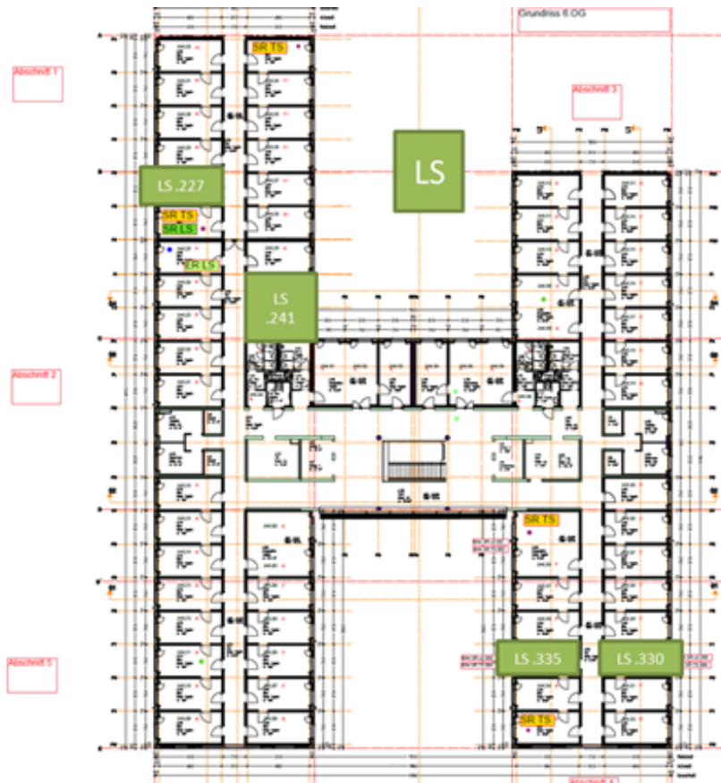
Abbildung 11: Positionen der Luftschallmessungen ©Kaufmann Bausysteme GmbH
