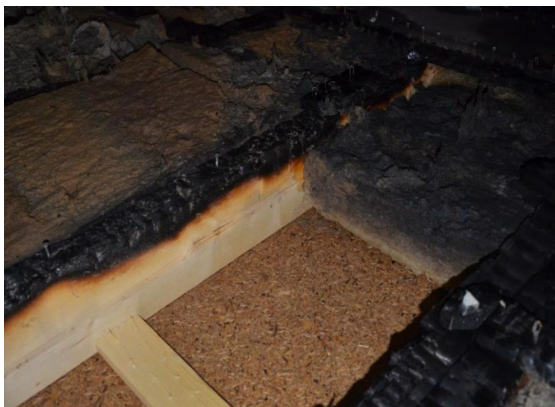
Abbildung 5: Schutzwirkung der Steinwolle-Dämmung für die Gefache [10]
