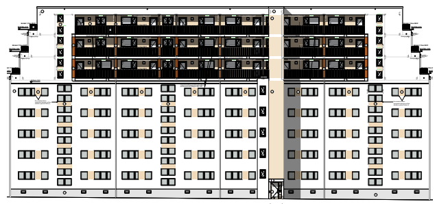
Dachaufstockung in Berlin-Buch
