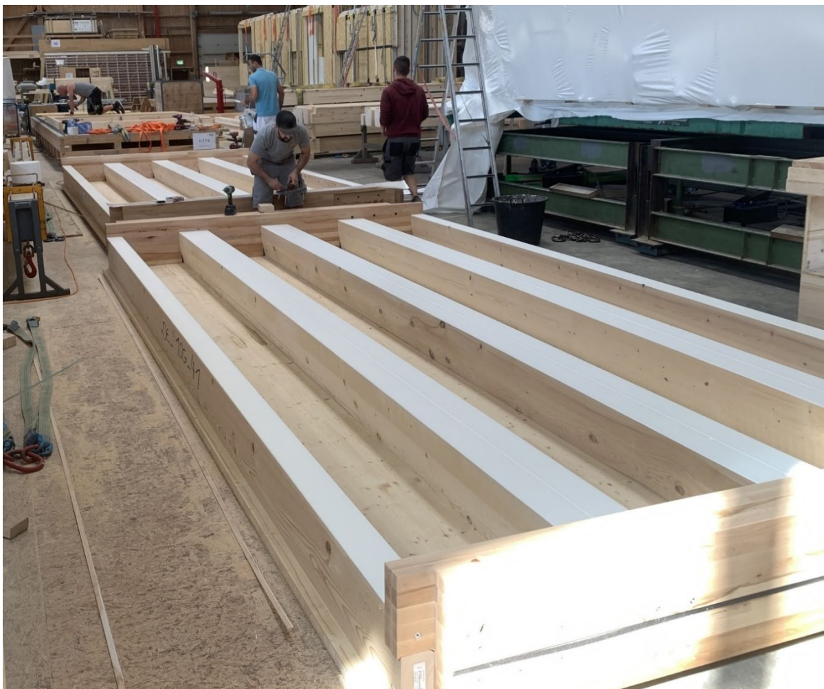
Abbildungen 12: Massivholz-Doppelträger C24, 2 x 120 / 260 mm, BSP-40mm, Elemente ca. 2.8 x 5.4 m
