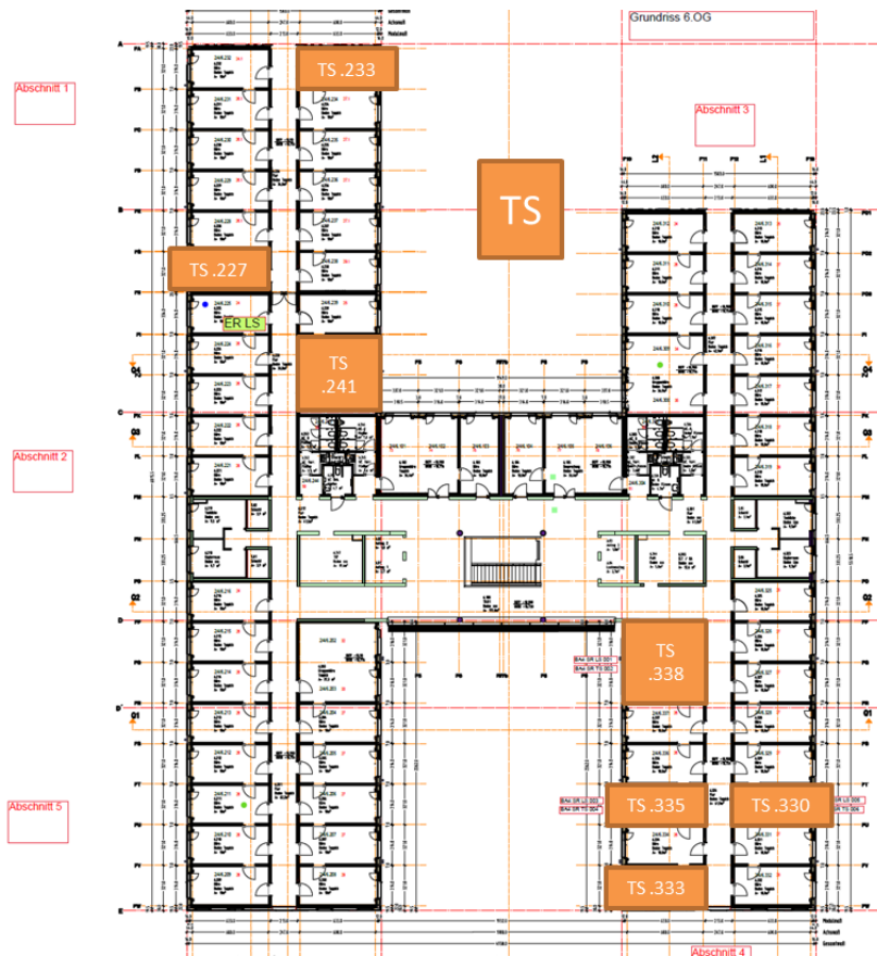
Abbildung 10: Positionen der Trittschallmessungen ©Kaufmann Bausysteme GmbH
