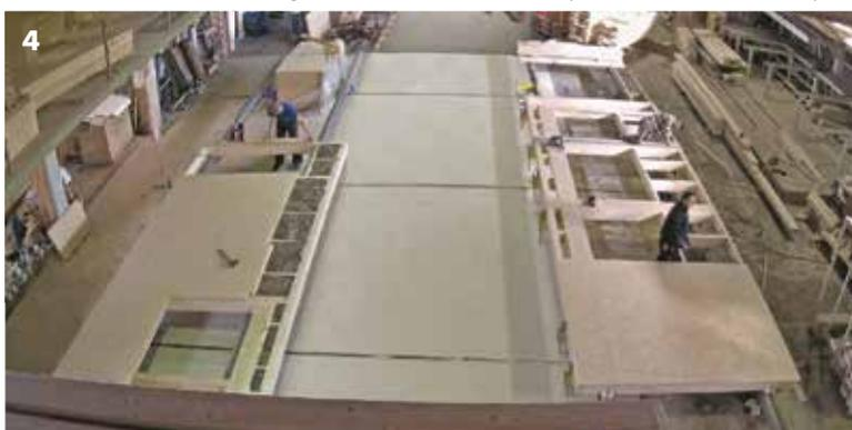
4 / Fabrication d'un élément mural à une hauteur de travail idéale : parfaitement ergonomique même pour la pose de piliers lourds, puisque la « table est praticable »
