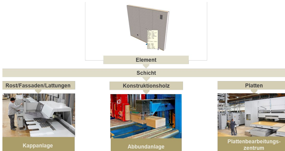
Abbildung 2: Eigene Darstellung: Vom BIM-Modell in die Produktion
