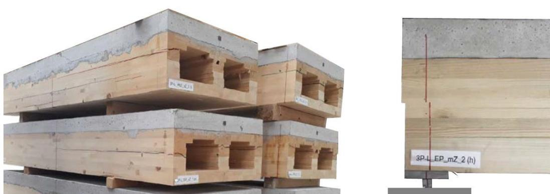
Abbildung 6: Kurze, gedrungene Lignotrend-HBV-Träger nach den Drei-Punkt Biegeversuchen zum Test der Schubtragfähigkeit: Immer Schubversagen im Holz der Stege
