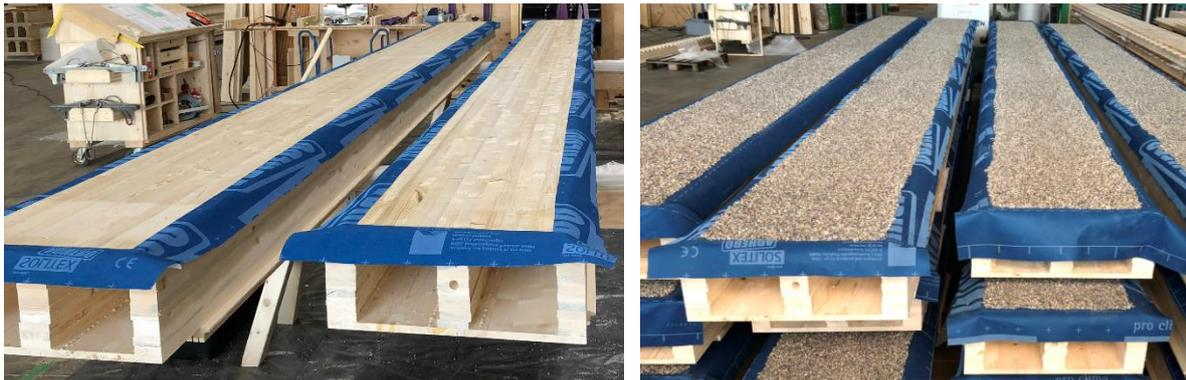
Abbildung 7: Fertigung: Lignotrend-Element vor und nach dem Auftrag der Splittverklebung © Lignotrend
