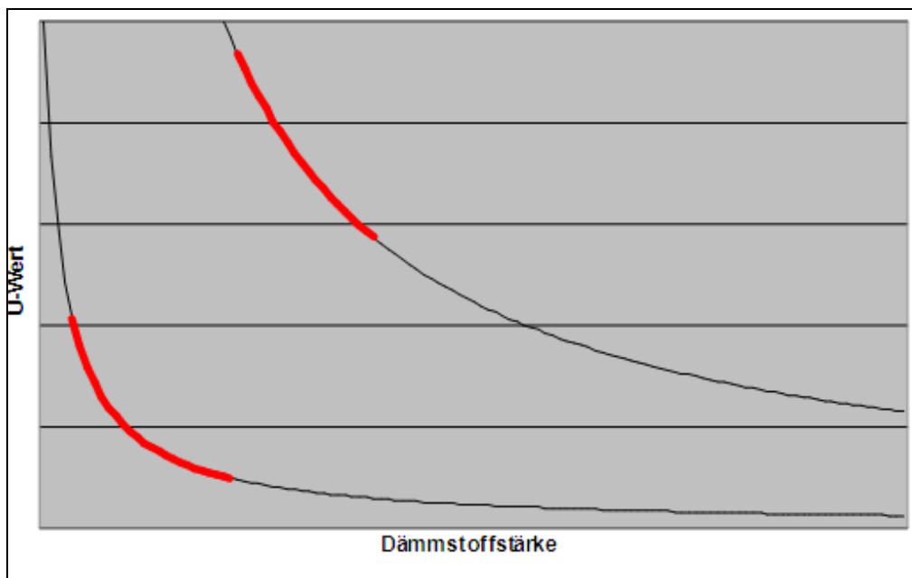
Abbildung 6: Schematische Darstellung der U-Werte von zwei opaken Bauteilen als Funktion der Dämmstoffstärke. Die hervorgehobenen Abschnitte der Hyperbeln repräsentieren „lohnende Verbesserungen“
