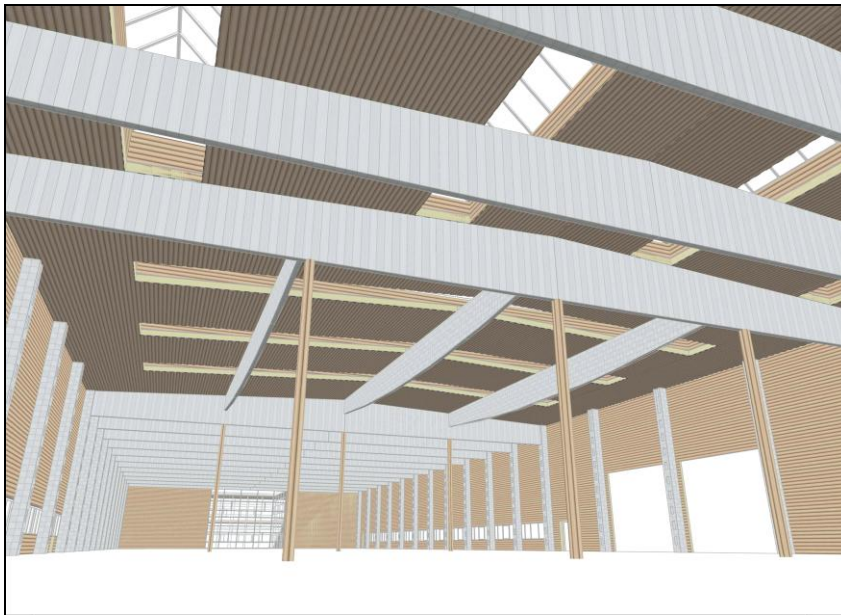
Abbildung 2: Innenansicht mit Tragstruktur und Oberlichtern
