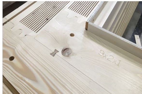
Abbildung 2: CNC-Verbindungen ermöglichen eine isolierende, luftdichte, strukturelle Gebäudehülle aus reinem Holz
