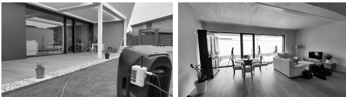
Figura 9: Misura dell'isolamento acustico di facciata in soggiorno con serramento di 6,20m di lunghezza (indice  $R_w$  risultante pari a 41dB).
