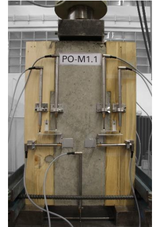
Push-Out Versuch an der MPA Stuttgart
