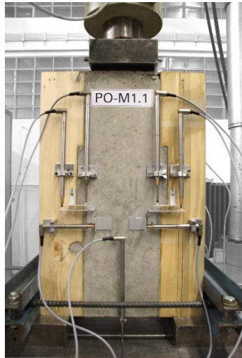
Push-Out Versuchskörper mit Wegaufnehmern
