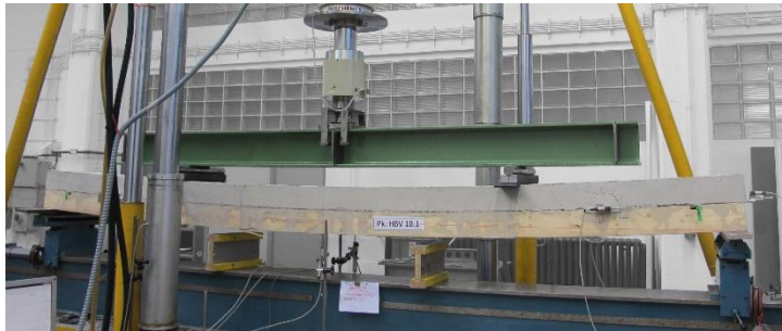
HBV-Träger im Versuch: Schubträger 4,0 m
