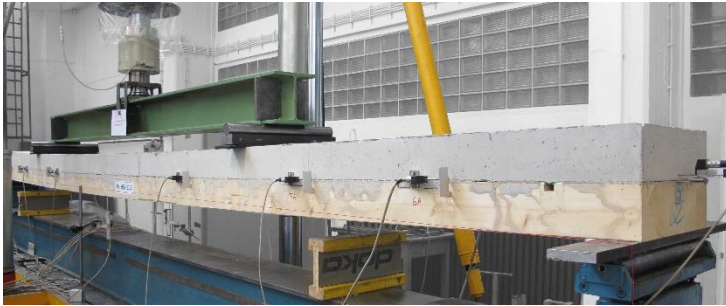
HBV-Träger im Versuch: Biegeträger mit 6 Kernen, Länge: 6,0 m
