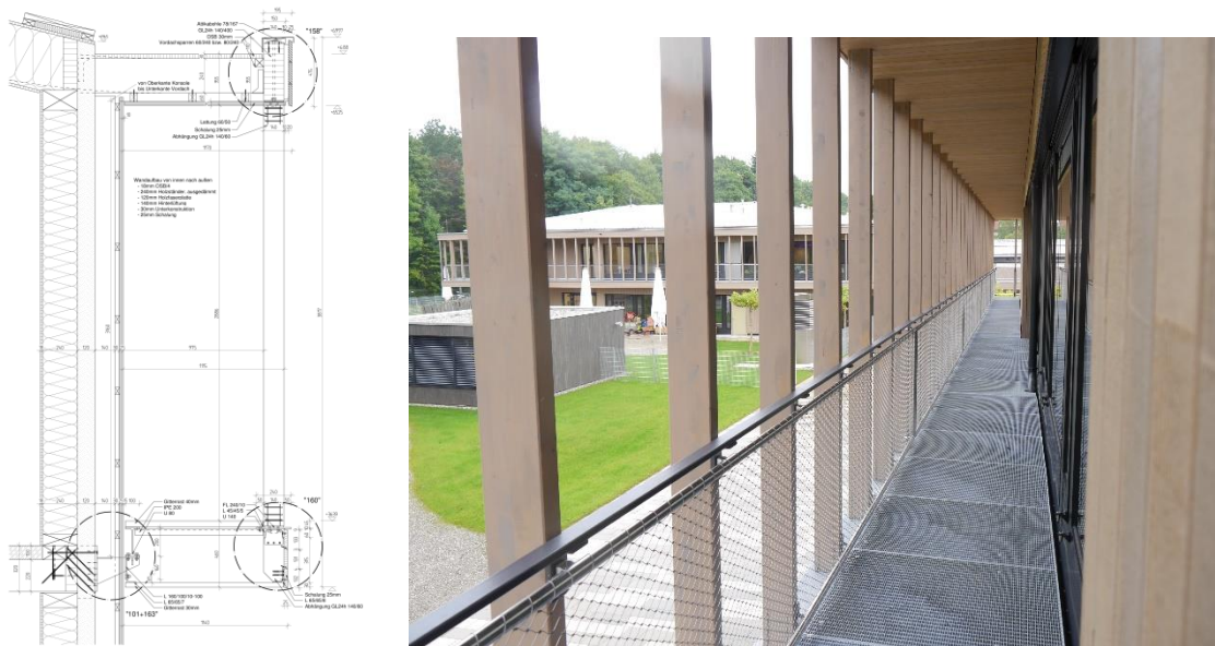
Abbildung 6: Abgehängte Balkonkonstruktion – Grundschule Pullach
