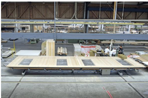
Abb. 6 + 7: Produktion der Massivholzwände im Werk
