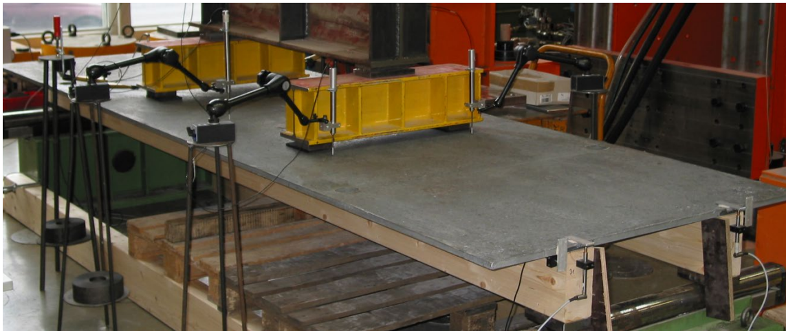
Abbildung 3: Erste Bauteilversuche mit verklebten Bauteilen aus Holz und ultra-hochfestem Beton (UHPC) von Schäfers [10]
