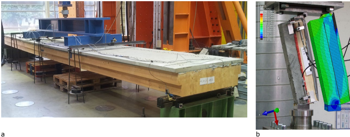
Abbildung 5: (a) Bauteilversuch mit flächigen Bauteilen (b) Versuchsaufbau für Scherversuche und FE-Modell zur Untersuchung des Einflusses unterschiedlicher Oberflächen
