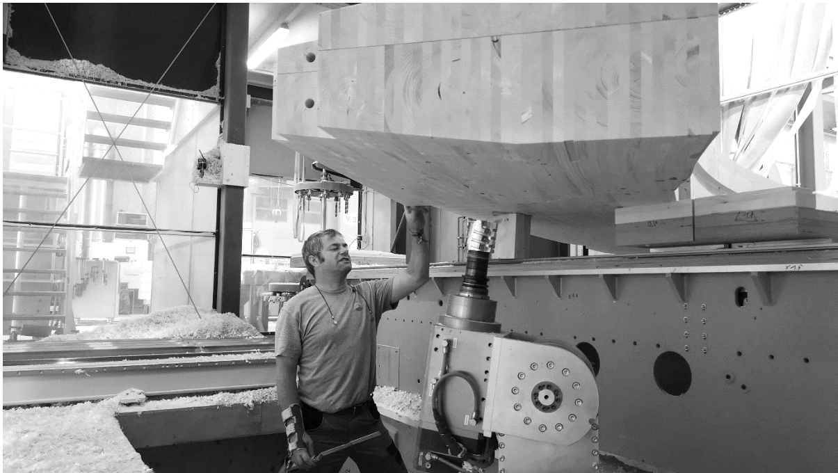
Abbildung 6: Bogenbinder wird auf der CNC-Maschine bearbeitet
