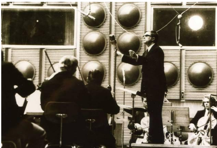
Abbildung 10: Versuch im Sendesaal des HR. Verbesserung der Versorgung mit frühen Schallreflexionen auf dem Orchesterpodium mit Publikumsbefragung.
