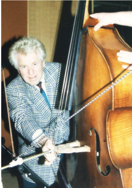
Abbildung 11: Anregung eines Musikinstrumentes, Kontrabass, am Steg und Messung der Impulsantwort mit TEF.
