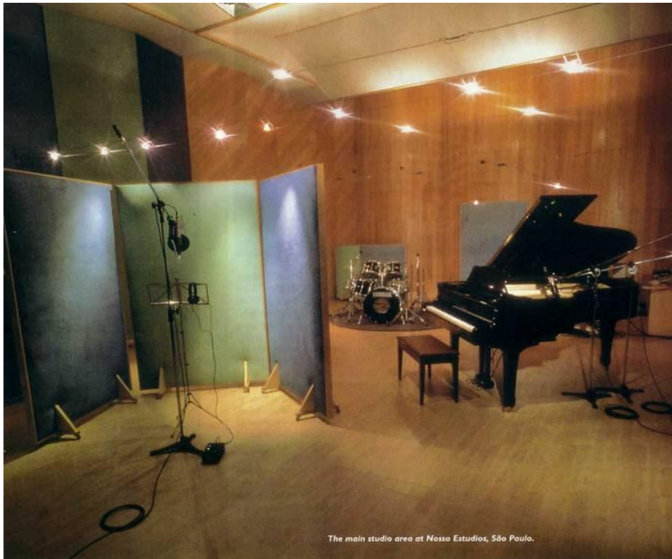
Abbildung 8: Aufnahmestudio mit diversen Schallabsorptionen als Holz, Stoff, Stellwände, Vorhänge, Stoff unter Lichtverteilung, gewölbte Holzwand. Mikrofone für Nahaufnahmen.
