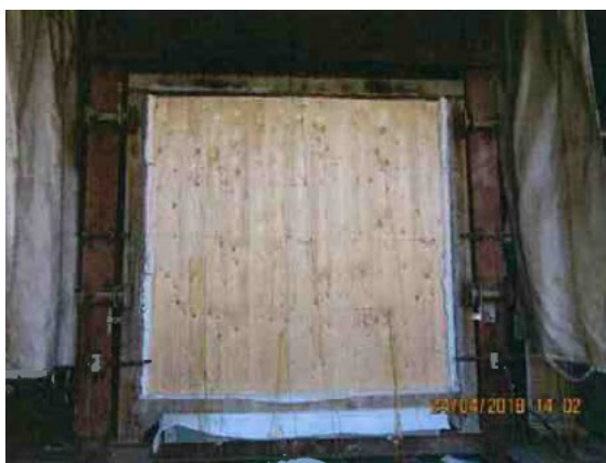
Foto 3: lato non esposto al fuoco dopo la prova Foto 3: side not exposed to fire after the test
