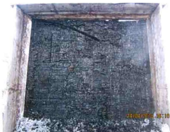
Foto 4: lato esposto al fuoco dopo la prova Foto 4: side exposed to fire after the test
