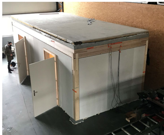
Abbildung 8: Versuch Deckenelement mit unterschiedlichen Bodenaufbauten und Wohnungstrennwandtypen beziehungsweise -anschlüssen
