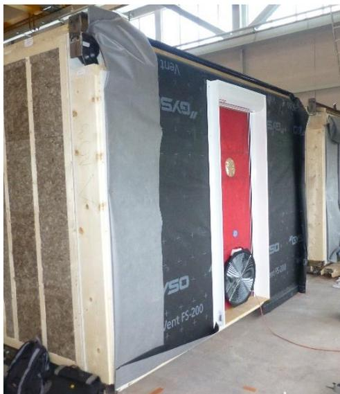
Abbildung 4: Blower-Door-Test am Modul
