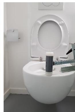
Abbildungen 6 – 8: Messung der Luft- und Trittschallübertragung sowie der Geräusche haustechnischer Anlagen
