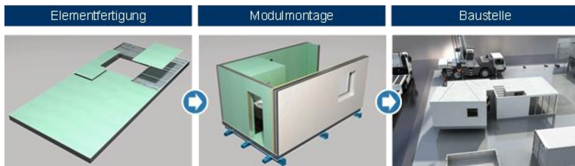
Abbildung 1: Produktionsprozess im modularen Hausbau
