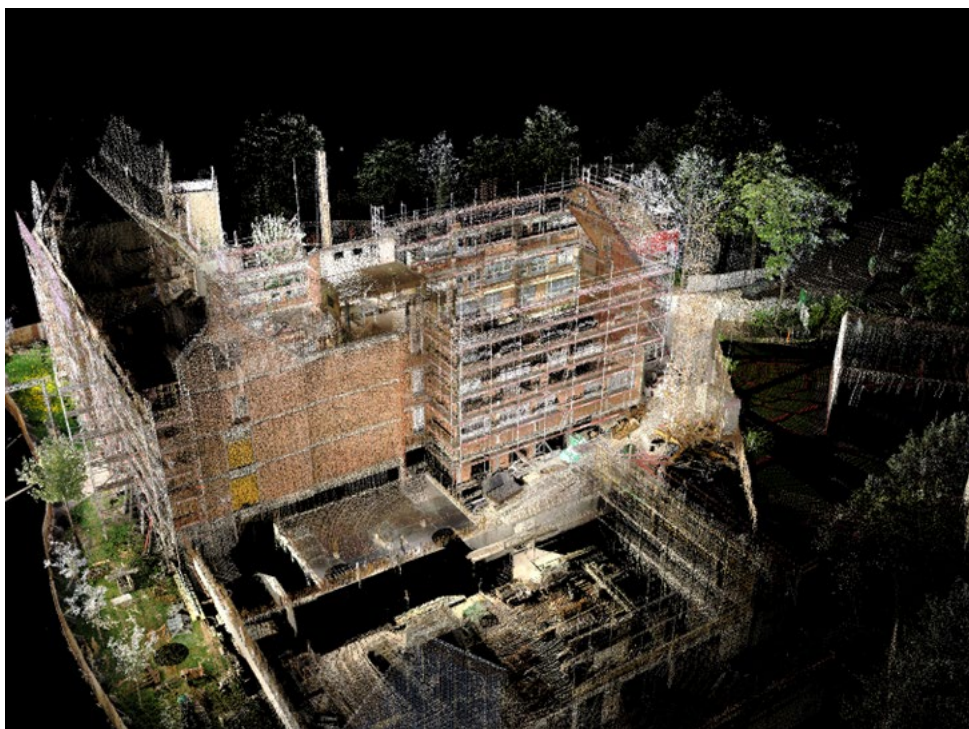
Abbildung 6: Digitales Gebäudeaufmaß mit 3D Laserscan
