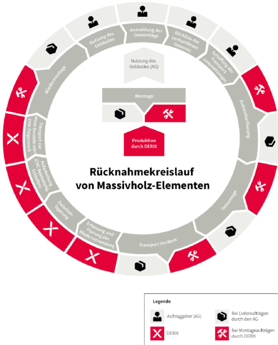
Abbildung 8: Rücknahmekreislauf von Massivholzelementen bei der DERIX Gruppe
