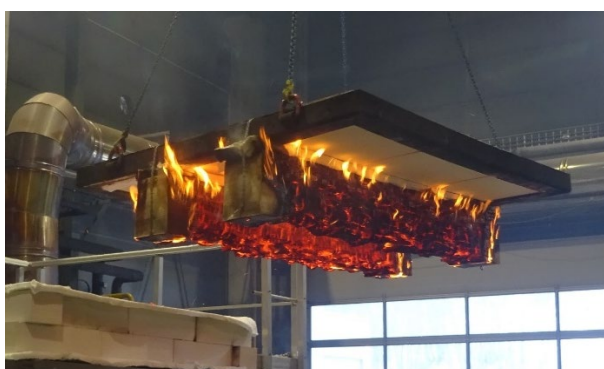
Abbildung 4: Brandversuche mit Brettschichtholz
