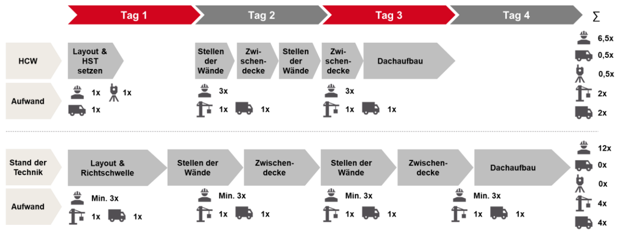
Abbildung 15: Beispielhafte Gegenüberstellung zwischen klassischen und modernen Verbindungsmitteln
