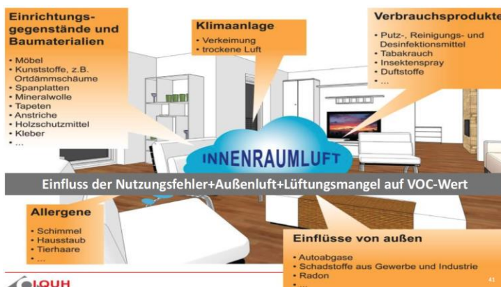
Abbildung 2: Baustoff-, nutzer- und standortbezogene Einflussfaktoren auf die Raumluftqualität
