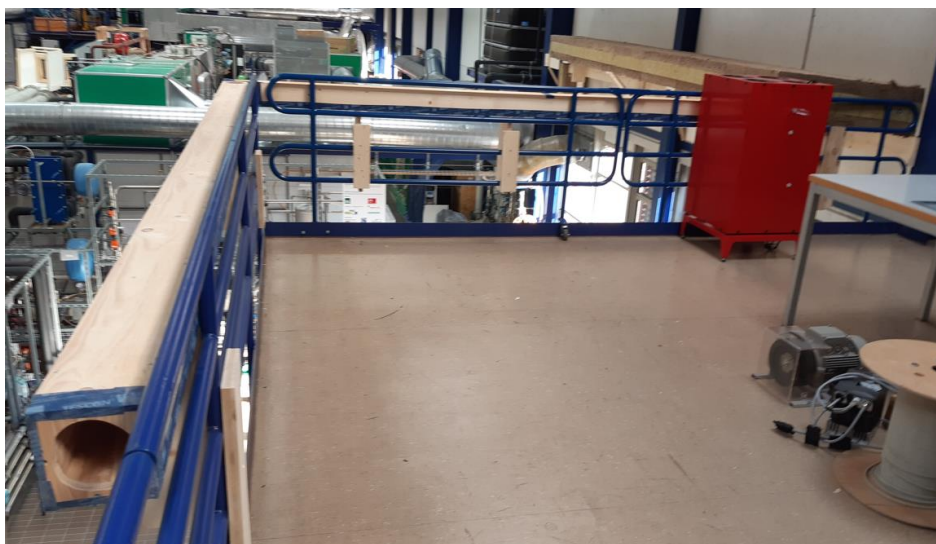
Abbildung 7: Vorbereitung Laboraufbau für die Untersuchung von Luftkanälen aus Holz [11]
