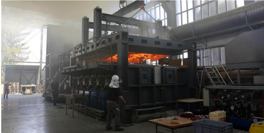
Abbildung 8: Grossbrandversuch unter Last
