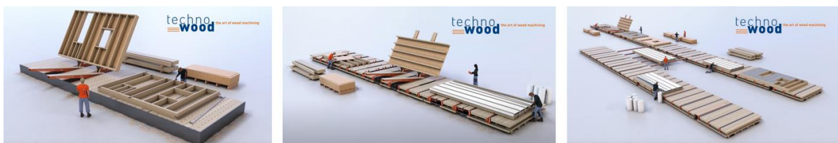
Abbildung 4: TW-Concept Line, die modularen Tische
