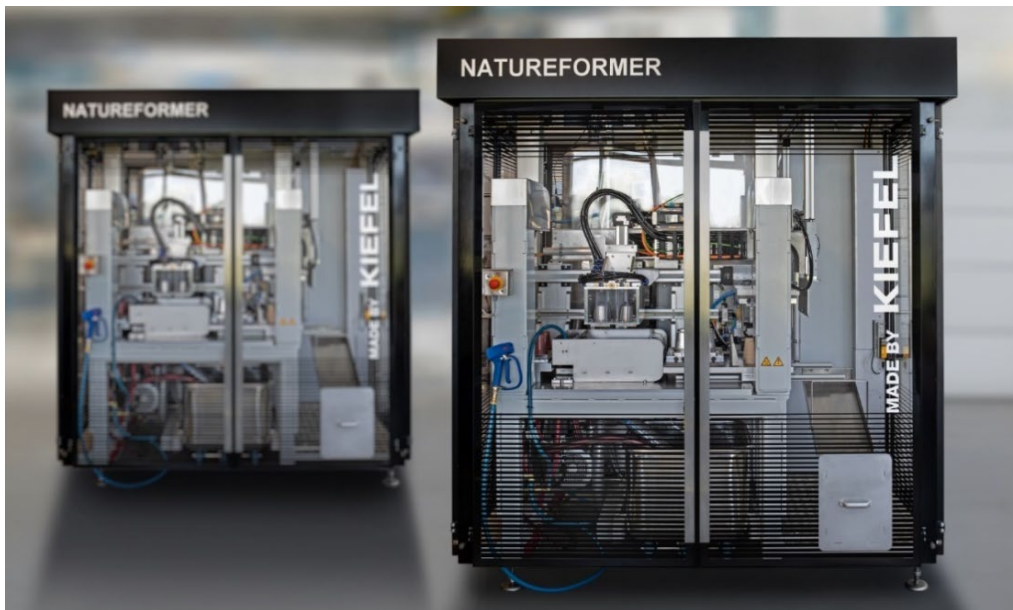
Abbildung 2: Auf der Versuchsanlage NATUREFORMER KFT Lab können Muster von Faserverpackungen hergestellt werden. Sie funktionieren genauso wie die Großserienmaschinen NATUREFORMER KFT 90 von Kiefel. © KIEFEL GmbH
