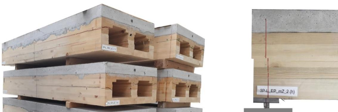
Abbildung 6: Kurze, gedrungene Lignotrend-HBV-Träger nach den Drei-Punkt Biegeversuchen zum Test der Schubtragfähigkeit: Immer Schubversagen im Holz der Stege
