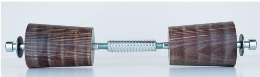
Abbildung 6: KP-Konusdübel, Einschraubmuffe, Zylinderkopfschrauben und Unterlegscheiben zur Auflagerfixierung des gabelgelagerten I-profilierten Trägers nach Abb. 7. (Foto: t-lab)
