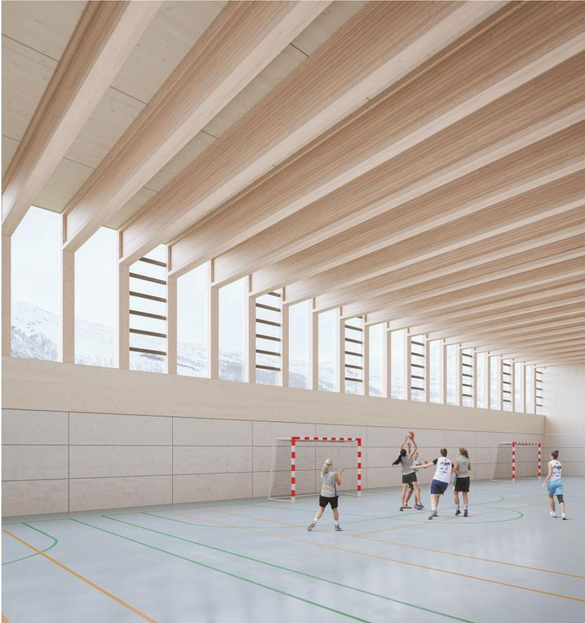
Abbildung 5: Beispielhafter, kreislaueffektiver Sporthallenentwurf (28 m Spannweite, 1,50 m Trägerabstand und lichte Raumhöhe von 7 m) mit standardisierten I-profilierten Buchenholzhybridträgern auf Stützen [12]. (Visualisierung: t-lab / Nicolai Becker Images, Stuttgart)
