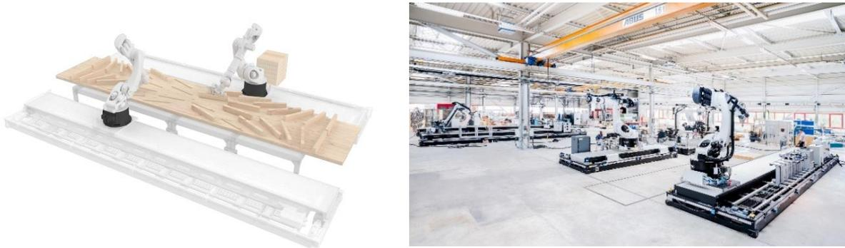
Abbildung 4: Geplante Fertigung der zweilagigen Holzdecken in der Halle des IntCDC, Waiblingen.
