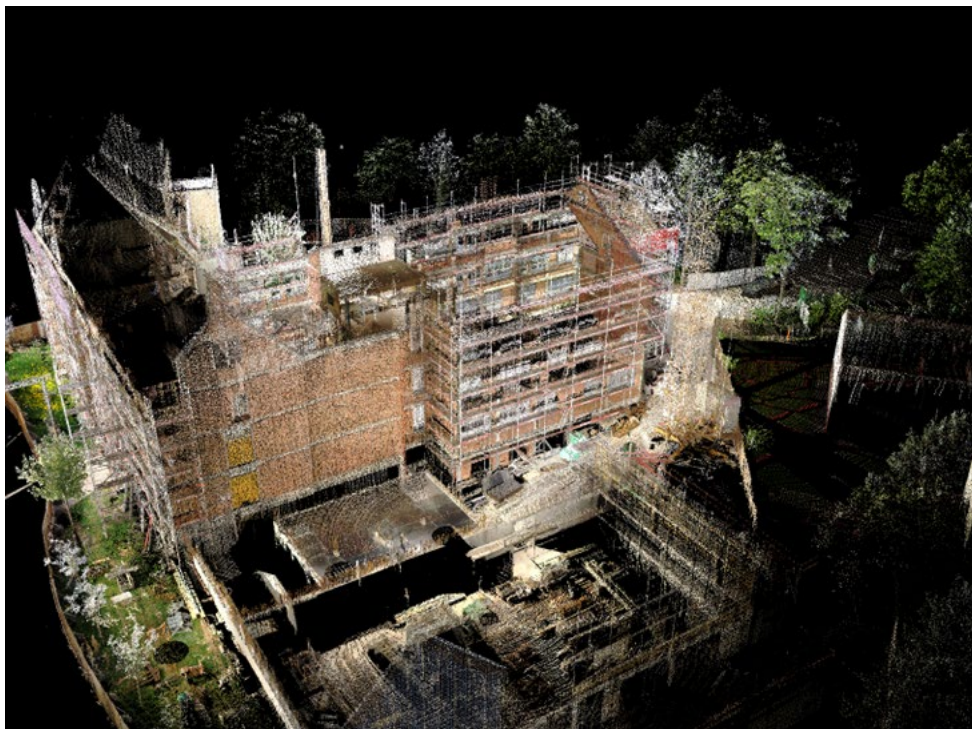
Abbildung 6: Digitales Gebäudeaufmaß mit 3D Laserscan
