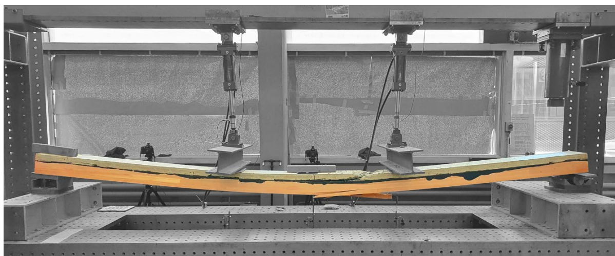
Abbildung 9: Vier-Punkt Biegeversuch mit verklebten Holz-Beton-Verbunddeckenelementen
