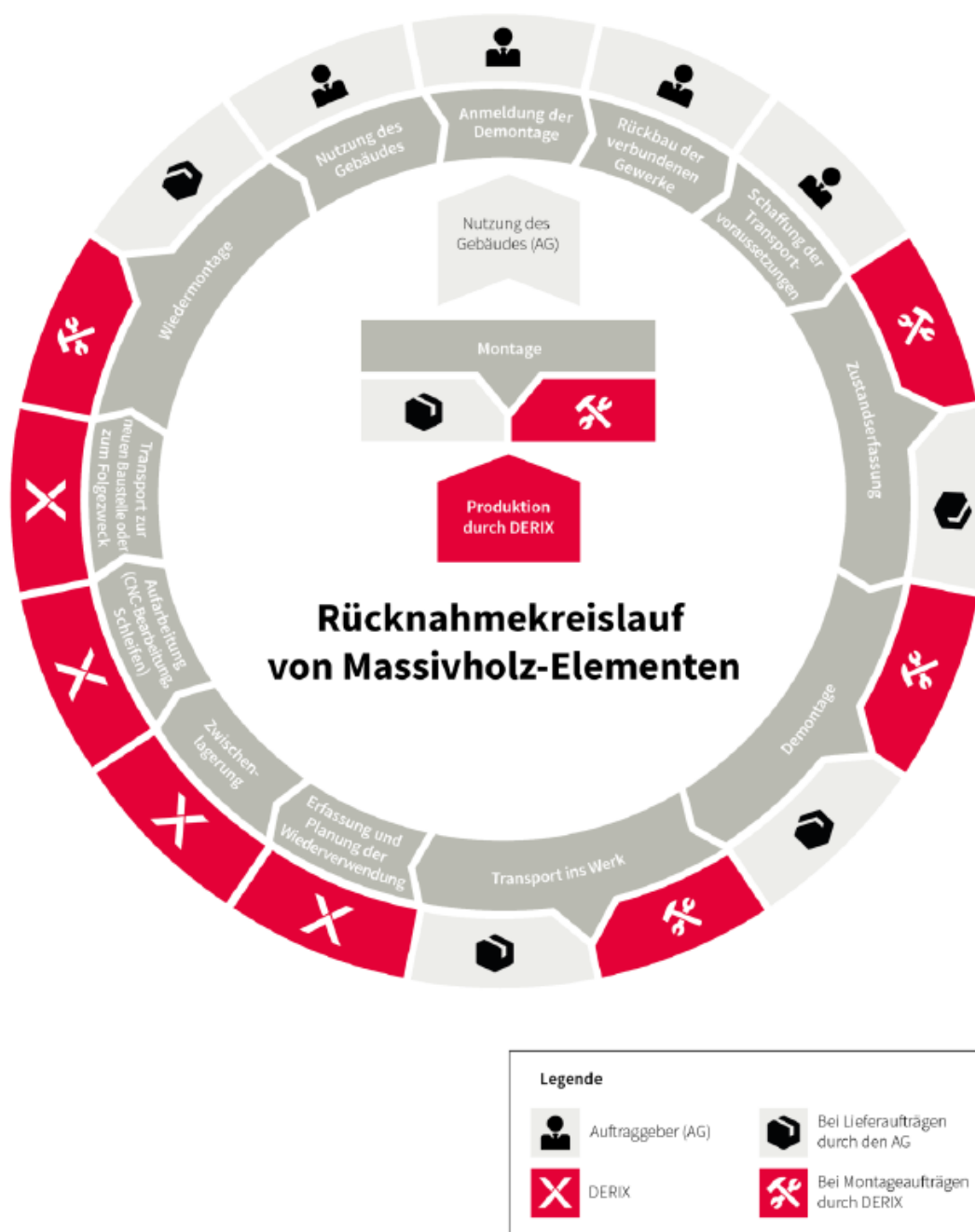
Abbildung 1: Rücknahmekreislauf von Massivholzelementen bei der DERIX Gruppe
