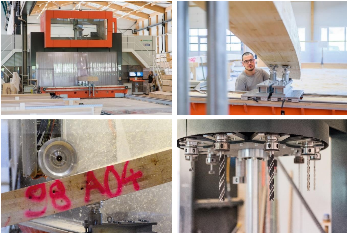
Abbildung 4: Die CNC-Anlage von Technowood ermöglicht eine präzise Bearbeitung der Holzbauteile.
