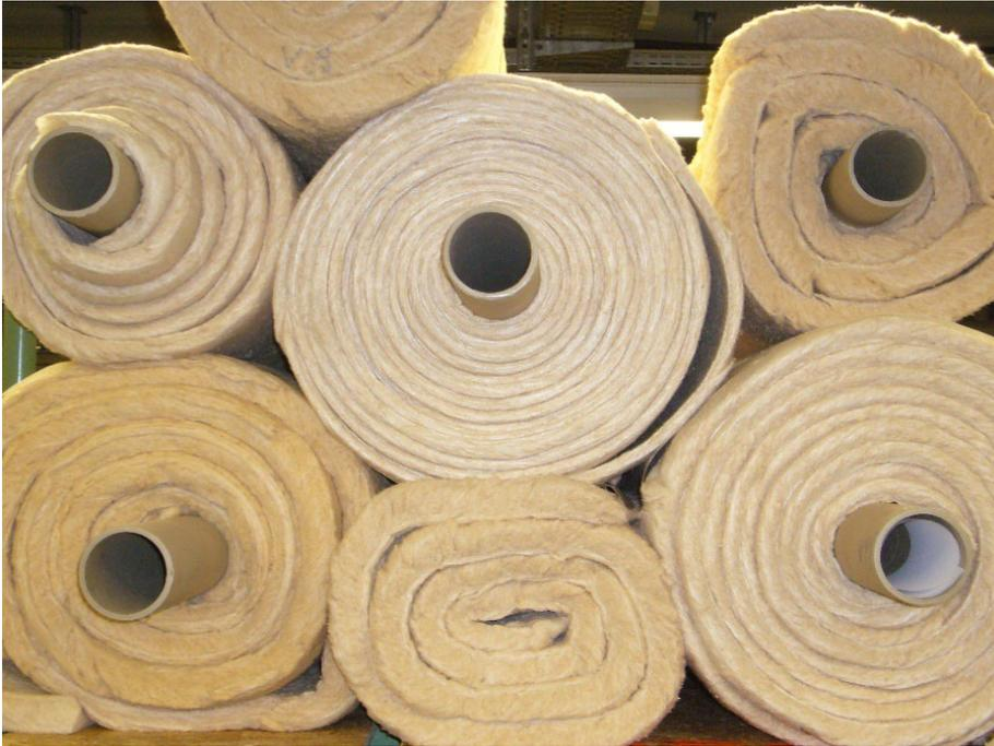
Abbildung 6: Erste hergestellte holzfaserbasierte Vliesstoffe.
