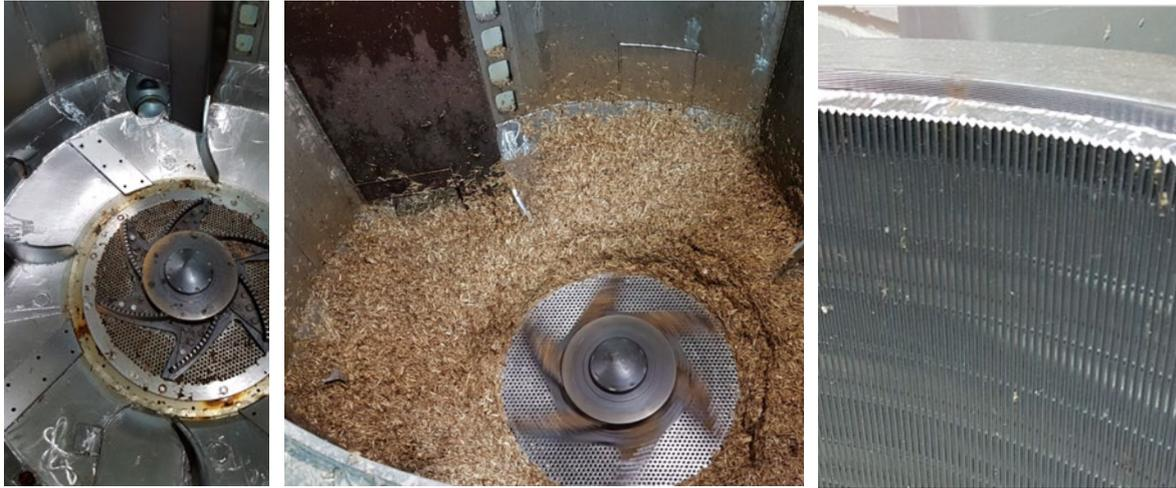
Abbildung 6: Links, Pulper-Einheit; Mitte, Pulper-Einheit mit Material; Rechts: Screening-Einheit (Mohr und Krug 2022).
