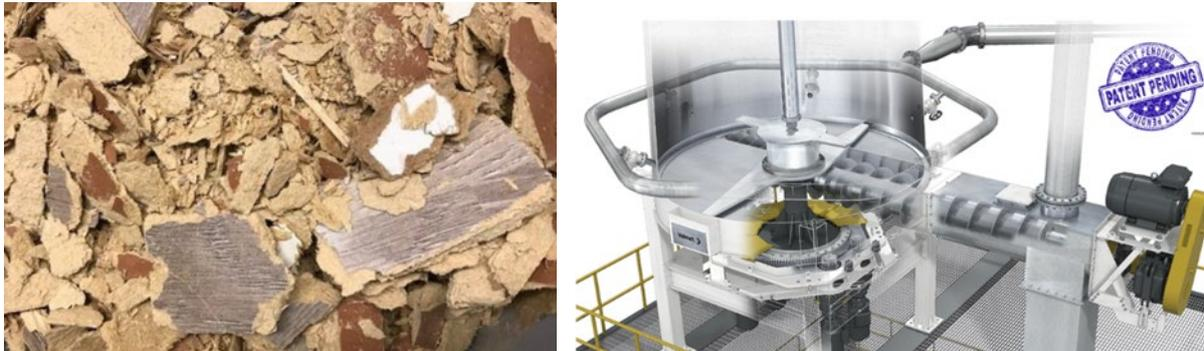
Abbildung 5: Links, vorgebrochenes HDF/MDF (beschichtet); Rechts, Hydrolysationseinheit (Mohr und Krug 2022).
