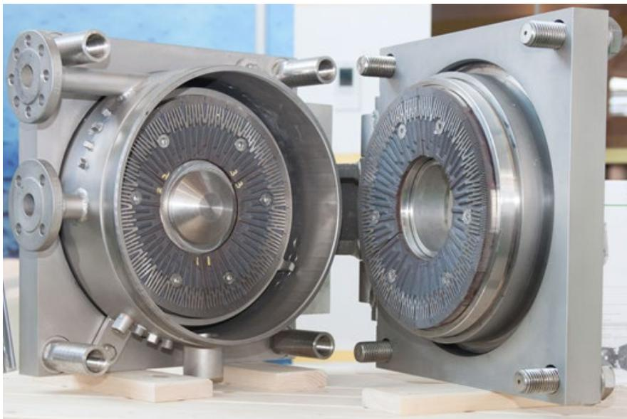
Abbildung 1: Modular aufgebautes Refinergehäuse des IHD mit Mahlscheiben.
