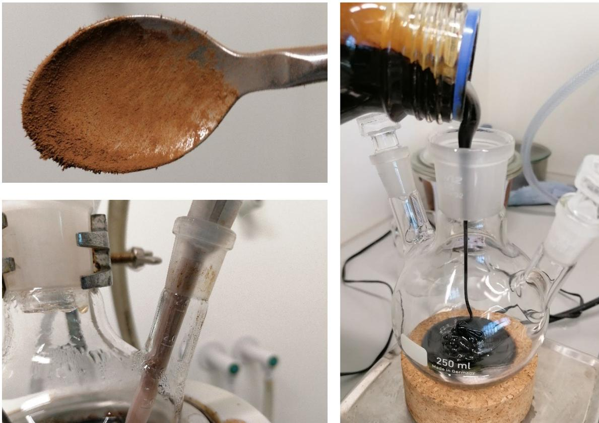
Abbildung 1: Arbeit mit pulverförmigem Lignin (links) und flüssigem Lignin-Phenol-Blend (rechts)
