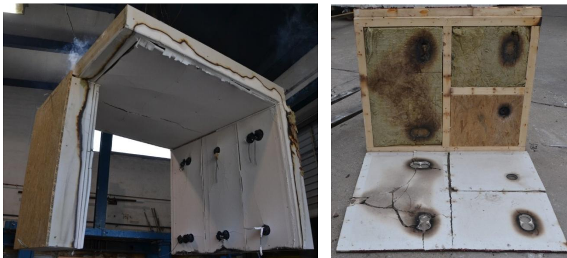
Abbildung 1: Prüfkörper unmittelbar nach dem Ende der Prüfung beim Herausheben aus dem Ofen und der anschließenden Begutachtung. Gut erkennbar ist die weitgehend intakte Brandschutzbekleidung, es haben sich nur sehr feine Risse gebildet und es sind keine Plattenteile abgefallen. Das Kapselkriterium wurde vollständig eingehalten.
