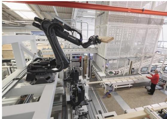
Abbildung 3 & 4: Roboter bei der Riegelwerkerstellung. Quellen: Randek AB bzw. Weberhaus
