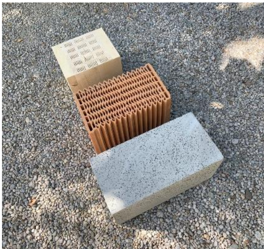
Abbildung 8: Die drei verwendeten Außenwandmaterialien: Massivholz und Ziegel – jeweils mit Luftkammern, sowie Infraleichtbeton. Foto: Tilmann Jarmer
