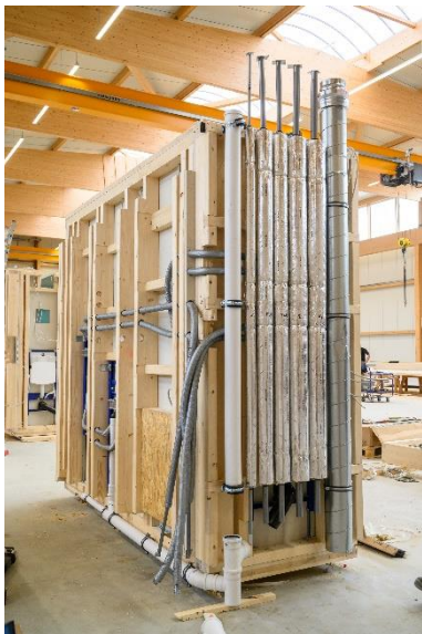
Abbildung 12: Badmodul/Technikmodul, Gebr. Schütt KG (GmbH & Co.)
