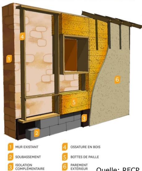
TECHNIQUE : ISOLATION THERMIQUE PAR L'EXTÉRIEUR (ITE)
