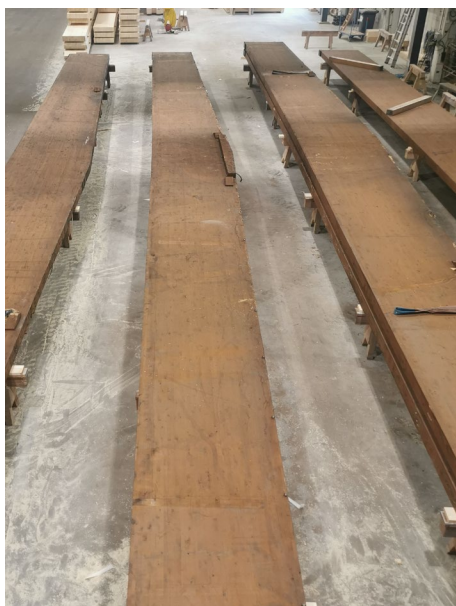
Abbildung 3: In TimberLoop werden gebrauchte BSH-Träger nach dem Rückbau begutachtet und Szenarien für den Re-Use entwickelt, © Holzforschung Austria
