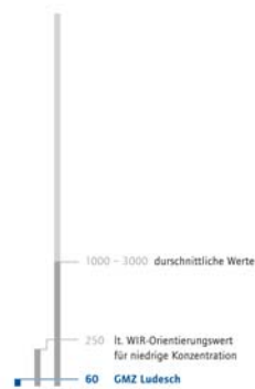
Luftmessung im Kursraum „Fossa“ Flüchtige organische Verbindungen (Gesamt VOC) TVOC µg/m 3 Unterschreitung der Österreich gültigen wirkungsbezogenen Innenraumrichtwerte (WIR) für Tetrachlorethen, Styrol und Toluol
