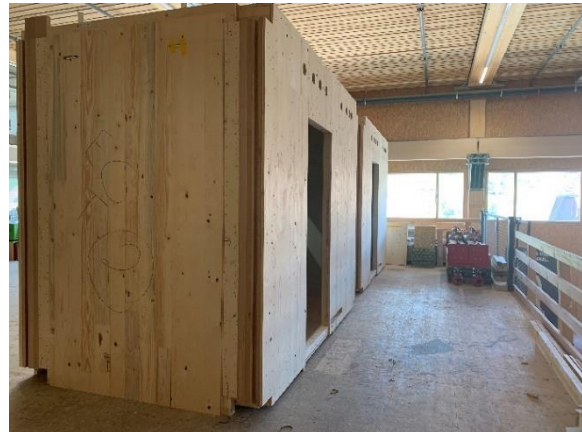
Abbildung 8: Badmodule in der Werkhalle
