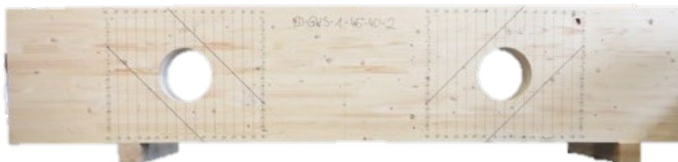
Abbildung 3: Erweiterte Bemessung und die Bemessung von Verstärkungen z.B. für Durchbrüche neu aufgenommen
