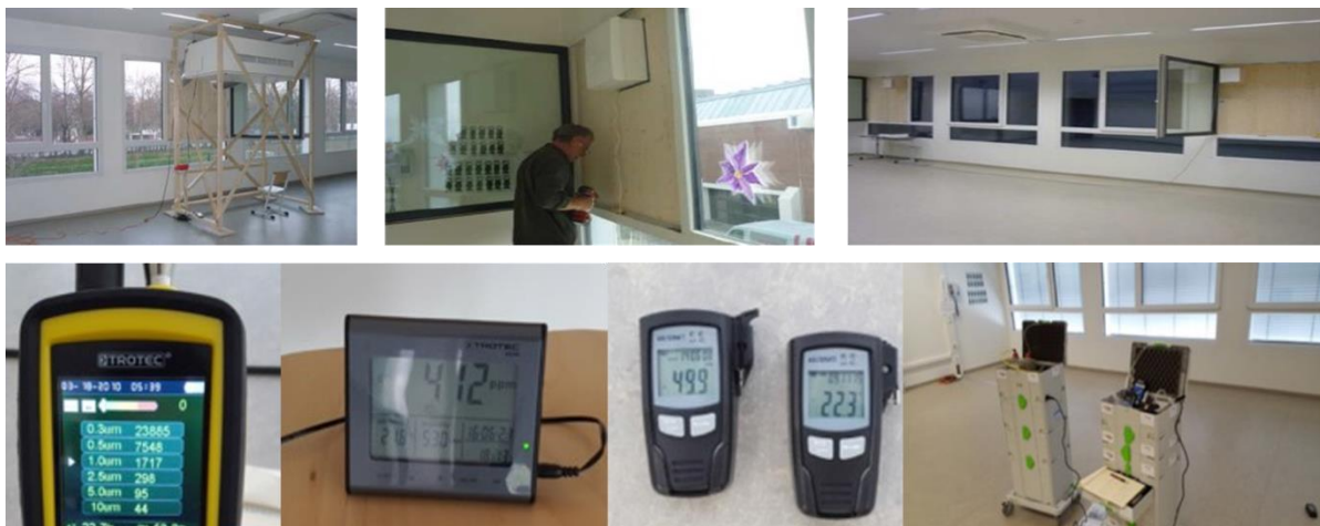
Abbildung 5: Test mit 3 unterschiedlich großen dezentralen Lüftungsanlagen im gleichen Klassenraum. Von links – Sensormessgeräte für Partikel, CO 2 , Feuchte/Temperatur, VOC Raumluftanalyse/Pumpenausrüstung.
