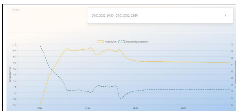
Abbildung 2: Klima Kontrollmessung Luftfeuchte und Temperatur vor einer VOC Raumluftmessung
