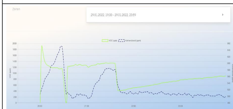
Abbildung 3: Lüftungsnachweis über CO 2 /VOC Sensorwert vor VOC Luftmessungen
